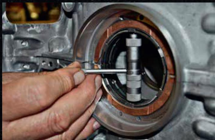
Le jeu assemblé peut être confirmé à l'aide de la jauge ACL Flexigauge (voir ACL Engineering Bulletin EB003/2016).
