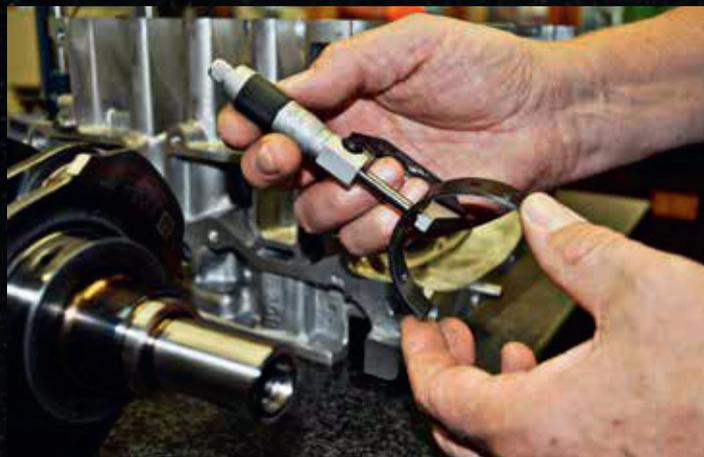
La meilleure façon de mesurer le jeu de palier vertical est d'assembler le palier dans son logement, avec les boulons serrés au couple spécifié puis, à l'aide d'une jauge d'alésage, de mesurer le diamètre intérieur assemblé des paliers à 90 degrés par rapport aux faces de séparation.
