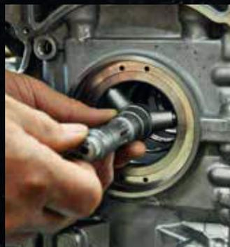
Les mesures d'épaisseur de la paroi du palier sont effectuées à 90 degrés du plan de joint (c-à-d. au niveau de la couronne du palier) à l'aide d'un micromètre muni d'un palpeur à billes, à utiliser sur le diamètre intérieur incurvé du palier.
