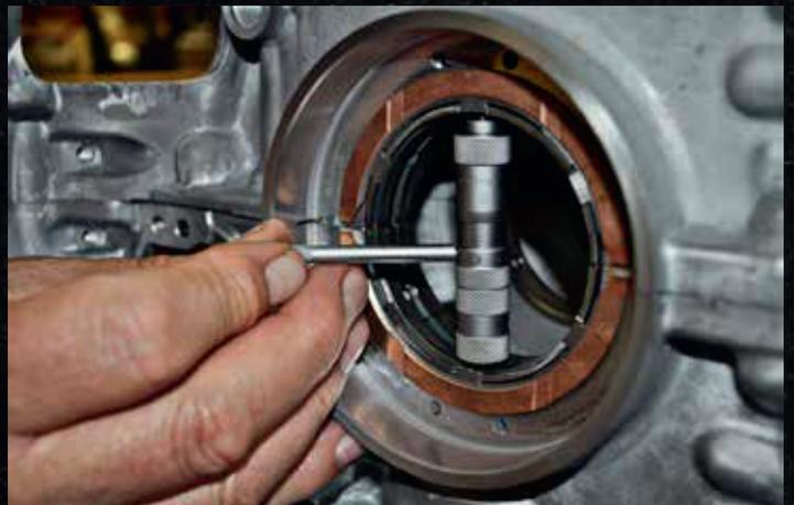
La holgura montada puede confirmarse utilizando un Flexigauge de ACL (véase el Boletín de Ingeniería EB003/2016 de ACL).
