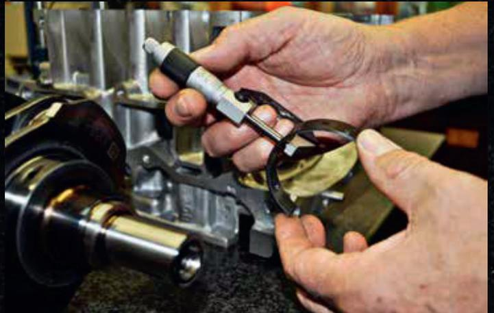
La holgura de aceite vertical se mide mejor montando el rodamiento en su alojamiento, con los tornillos apretados según las especificaciones, y midiendo con un calibre el diámetro interior montado de los rodamientos a 90 grados de las caras de separación. Se mide el tamaño del gorrón del cigüeñal de contacto y se resta dicha medida al tamaño del diámetro interior del rodamiento para obtener la holgura de aceite montada.
