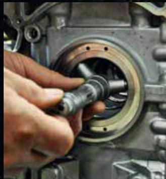
Las mediciones del espesor de la pared del rodamiento se realizan a 90 grados de la línea de separación (es decir, en la corona del rodamiento) utilizando un micrómetro de yunque de bola, para establecer el diámetro interior curvo del rodamiento.
